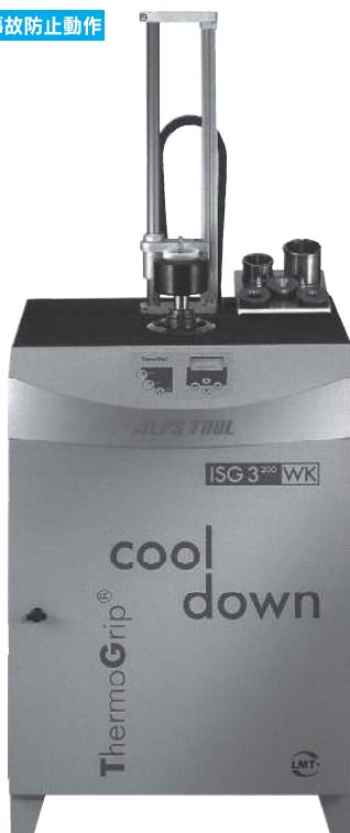
電磁誘導で急速加熱、水冷冷却で急速冷却。最適な局部加熱を実現し、チャッキング部分以外を熱くしない。冷却は防錆剤入り冷却液を吹き付ける事で急速にチャックの熱を取り去る。刃物交換後にチャックがなかなか冷えず、直ぐに加工に使用出来ないと言う悩みを解決。サモグリップチャックレギュラータイプとの併用で、超硬工具・ハイス工具・スローアウェイ工具の着脱が可能。
