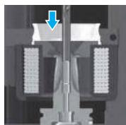
電磁誘導加熱で熱効率は極めて高く、瞬間加熱を実現する。焼きバメチャックの局部のみを短時間に加熱する事が可能。
